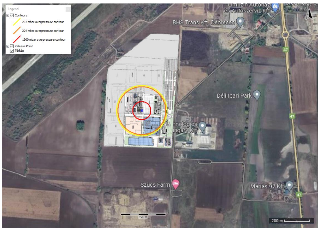
18. ábra: A cseppfolyós oxigéntartály robbanásának övezetei
